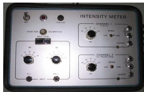
Figura 7. Nome: Intensímetro. Modelo: HP 500. Fabricante: F.J. Eletronics, da Dinamarca.
